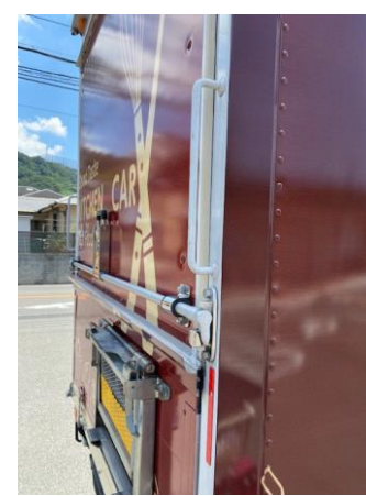
後方扉施錠部分
